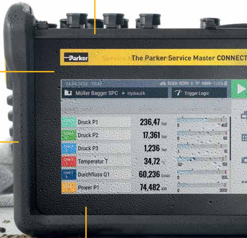
Für Handschuhbedienung geeignet, robustes 3 mm Glas, Auflösung 800 x 480 Pixel
