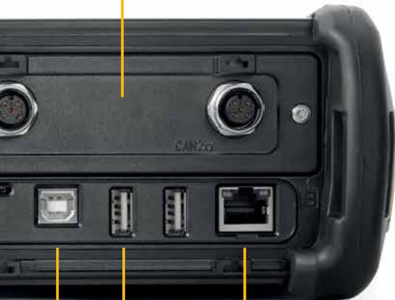
**LAN-Interface zur Fernüberwachung, Messwertübertragung oder Remote-Control**
